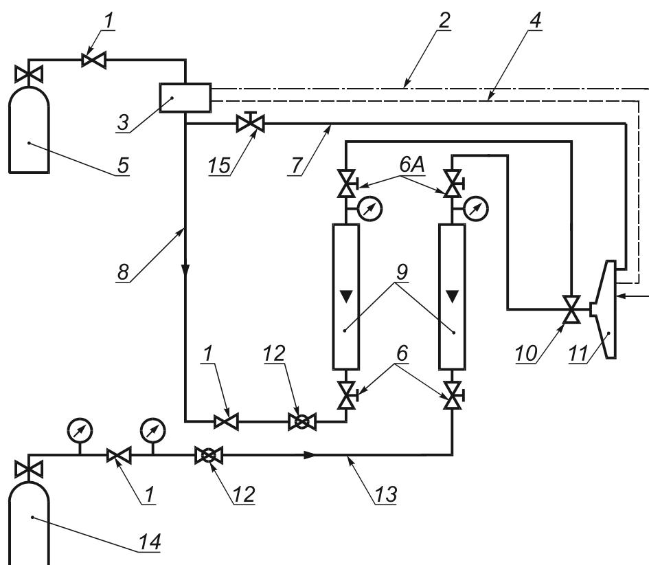
1 — регулятор; 2 — пьезоэлектрический воспламенитель; 3 — устройство для прерывания работы горелки; 4 — контрольные термопары; 5 — баллон с пропаном; 6 — винтовой клапан (БА — альтернативное расположение); 7 — вспомогательное питание; 8 — поступление газа; 9 — расходомеры; 10 — смеситель Вентури; 11 — горелка; 12 — шаровой клапан; 13 — система подачи воздуха; 14 — баллон со скатым воздухом; 15 — винтовой клапан на вспомогательном питании
