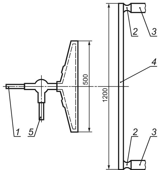
1 — подача воздуха; 2 — резиновая втулка; 3 — опорный каркас; 4 — горизонтальный стальной элемент испытательной лестницы; 5 — подача пропана
