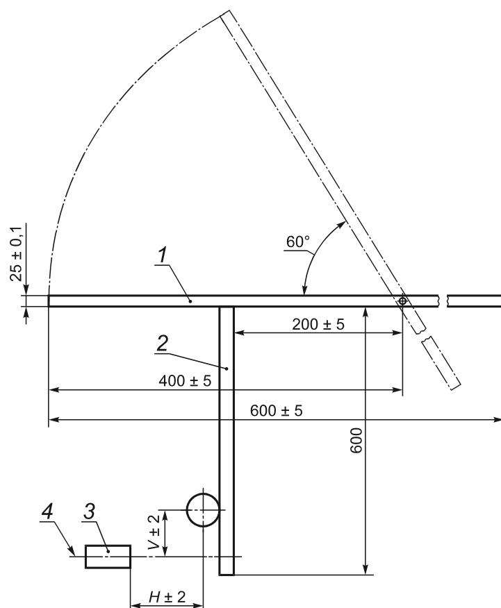
1 — ударное устройство; 2 — стальная испытательная лестница; 3 — газовая горелка; 4 — осевая линия фронтальной поверхности горелки;  $H$  — расстояние осевой линии испытуемого кабеля от фронтальной поверхности горелки по горизонтали;  $V$  — расстояние осевой линии испытуемого кабеля от осевой линии горелки по вертикали
