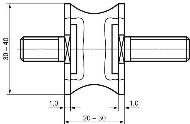
Рисунок 4 — Типовая резиновая втулка для крепления испытательной лестницы
